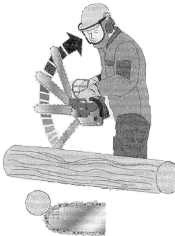
Рис. 5. Отдача цепной пилы
